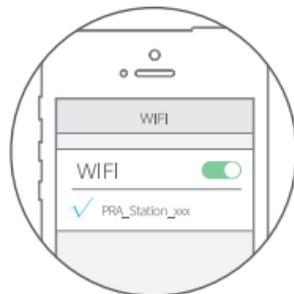
5. Schalten Sie auf einem Mobiltelefon oder einem anderen Mobilgerät das WLAN ein und verbinden Sie sich mit "PRA\_Station\_xxx", (das Standard-Passwort lautet "1234567890").
